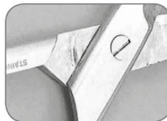
Złącze z oznakami zużycia spowodowanego niedostatecznym smarowaniem
